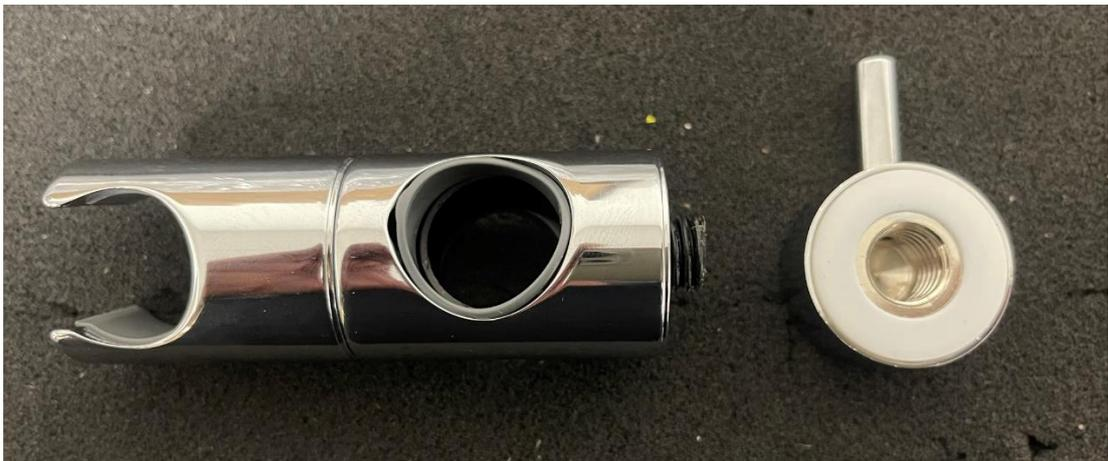
Etape 2 : Dévisser le disque métallique. Lorsqu'il est trop serré, il peut empêcher la bague noire de serrer sur le tube. La poignée est serrée à fond, la bague noire entre en butée contre le disque métallique qui la retient avant d'avoir pu obtenir un serrage normal du curseur.
