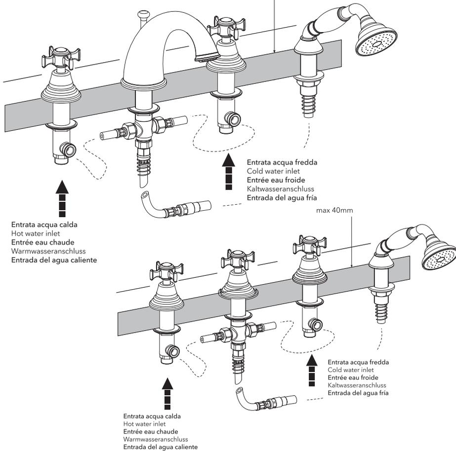
**MONTAGGIO E PEZZI IDENTIFICATIVI DI RICAMBIO - INSTALLATION AND SPARE PARTS - MONTAGE ET PIÉCES IDENTIFICATION DE RECHANGE - MONTAGE UND ERSATZTEILE - MONTAJE E IDENTIFICACIÓN DE LAS PIEZAS DE RECAMBIO MONTÁŽ A NÁHRADNÍ DÍLY - MONTÁŽ A NÁHRADNÉ DIELY**
