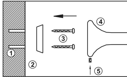
In corrispondenza dei due fori della placchetta (2), forare il muro con un trapano e inserire i due tasselli (1) nel muro. Quindi con le due viti (3) fissare la placchetta sulla parete. Posizionare il supporto (4) dell'articolo sulla placchetta e fissarlo con il grano (5) avvitandolo con la chiave a brugola in dotazione.
