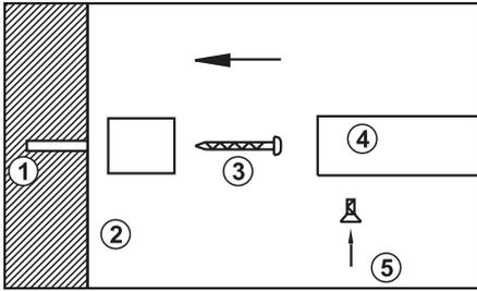
In corrispondenza del foro della placchetta (2), forare il muro con un trapano e inserire il tassello (1) nel muro. Quindi con la vite (3) fissare la placchetta sulla parete. Posizionare il supporto (4) sulla placchetta e fissarlo con il grano (5) avvitandolo con la chiave a brugola in dotazione.
