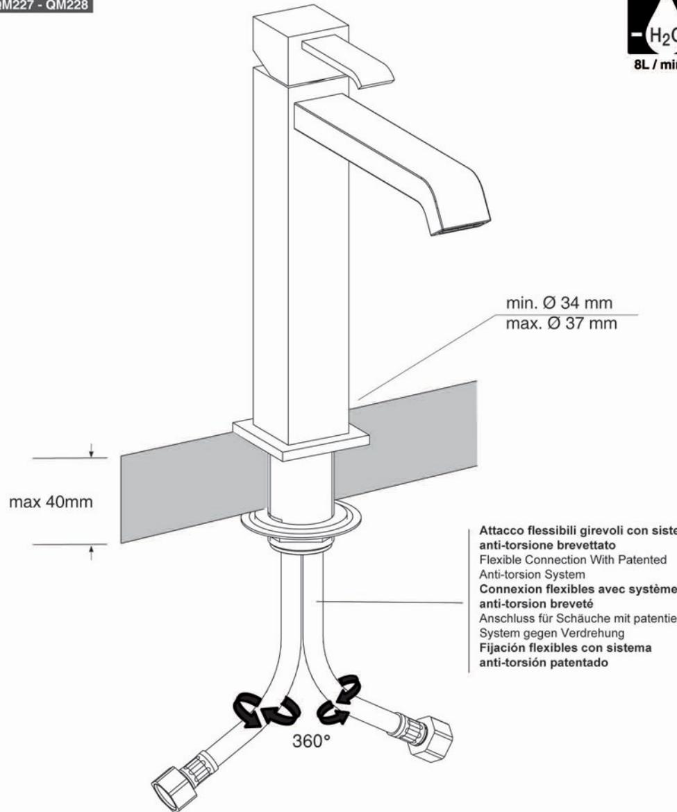
Montaggio e Pezzi di Ricambio - Installation And Spare Parts - Montage et pièces détachées
