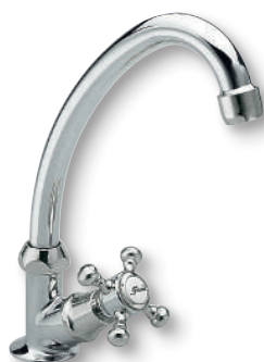
BALILLA eau froide bec tube orientable, hauteur 231 mm, saillie 144 mm, hauteur sous bec 169 mm, CHROMÉ | BL 14051 | 93 €
