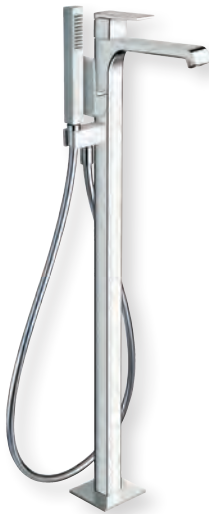
QUADRI S hauteur 883 mm, saillie 230 mm, flexible lisse 150 cm, mitigeur indépendant pour la douchette et le remplissage baignoire, douchette anticalcaire CHROMÉ | QS 18951 | 1 670€
