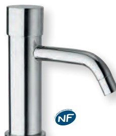
QUIK eau froide temporisation 8 à 30", hauteur 158 mm, saillie 109 mm, hauteur sous bec 54 mm, alimentation M 1/2" CHROMÉ | QY 23051 | 135€
