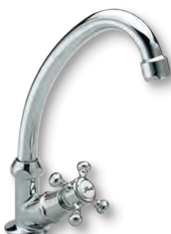
BALILLA eau froide bec tube orientable, hauteur 231 mm, saillie 144 mm, hauteur sous bec 169 mm, CHROMÉ | BL 14051 | 92€
