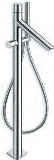
QUADRI S hauteur 883 mm, saillie 230 mm, flexible lisse 150 cm, mitigeur indépendant pour la douchette et le remplissage baignoire, douchette anticalcaire CHROMÉ | QS 18951 | 1 670€
