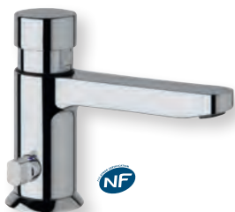
QUIK temporisation 13", hauteur 111 mm, saillie 110 mm, hauteur sous bec 68 mm, alimentation M 1/2" MÉLANGEUR | Q5 23251 | 99€
