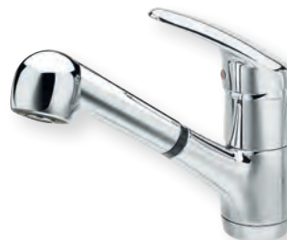
OLTRE évier + douche diamètre corps 55 mm, bec orientable, douche bi-jets amovible, hauteur 195 mm, saillie 200 mm, flexible longueur utile 80 cm, hauteur sous bec 118 mm CHROMÉ | SP 13451 | 243€
