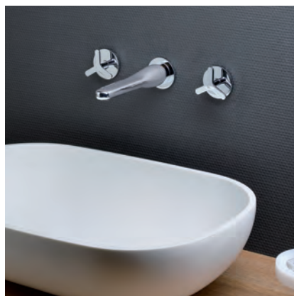
Mélangeur lavabo mural 3 trous* saillie 185 mm, aérateur orientable, profondeur mini d'encastrement 70 mm CHROMÉ | BE 24251 | 403€
